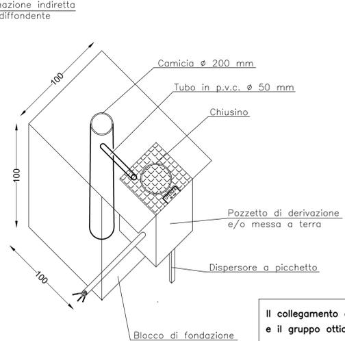
Il collegamento elettrico tra la linea principale e il gruppo ottico è previsto con cavi ø 2.5. Le giunzioni derivate sono previste con il metodo a resina colata.
